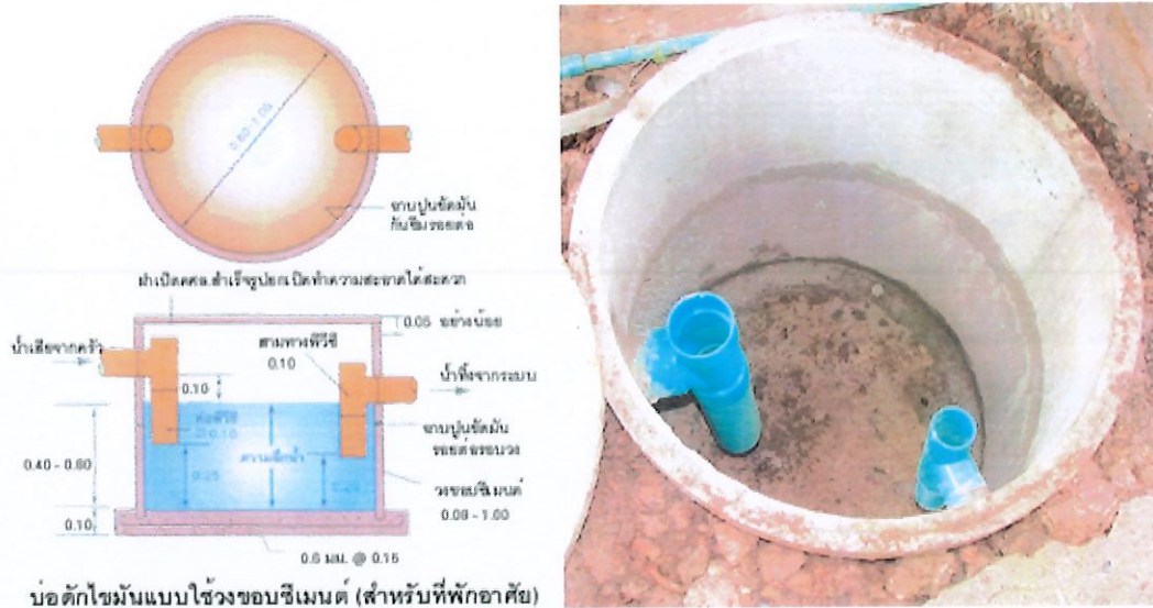
รูปที่ ๒ รูปแบบทั่วไปของบ่อดักไขมันแบบวงขอบซีเมนต์ (สำหรับที่พักอาศัย)
